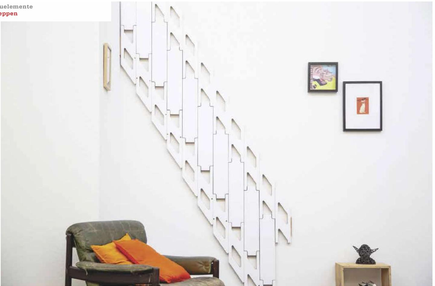
*/ Wenig Montagefläche zur Verfügung? Mit Klapster Slim kein Problem: Durch die geringe Stufentiefe von nur 13 cm benötigt das Slim-Modell deutlich weniger Wandfläche.*
